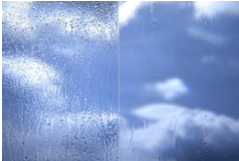
Figura 2: Vidrio normal después de la lluvia (izq). Vidrio autolimpiable (der).
